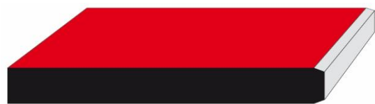
Figura 2.2: Panel con cantos biselados.
