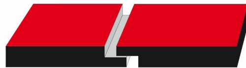
Figura 4.1: Junta con galce.
